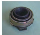
自動車部品 クラッチスリッパベアリング (アルミ軸を支える滑り軸受け)
