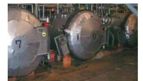
発売当時のレトルト釜。高温での加圧・加熱殺菌により保存料を使わず長期保存が可能に
