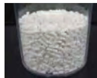
熱可塑性樹脂複合材料。精密部品、摺動部品などに使用
